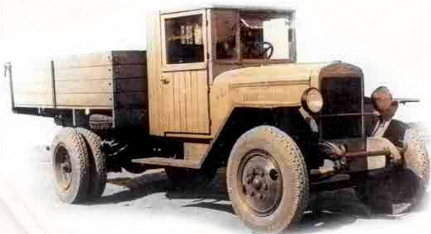
Упрощенный грузовик военного времени ЗИС-5В
