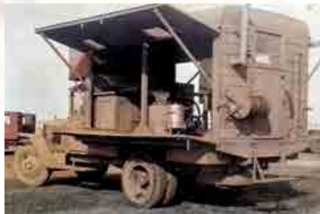
Авторемонтная мастерская типа «Б» и ее оборудование на шасси ЗИС-5В ульяновского производства
